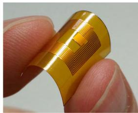
1mm角のセンサ部を持つセンサにより約130 ms間隔で非定常温度の測定
