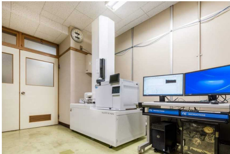
図3. 測定自動化・データ解析用ソフトウェアの充実化を実施した ガスクロマトグラフ質量分析計
