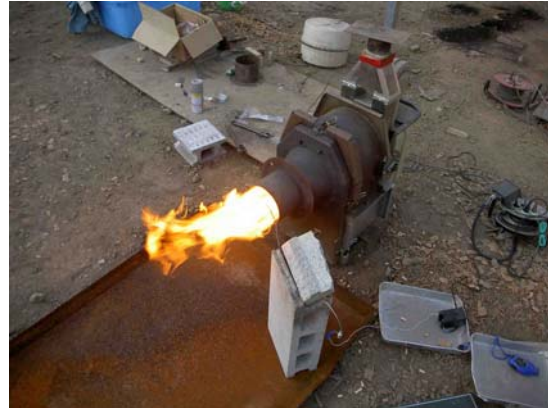
写真3-7. バーナー開発中(燃焼テスト)
