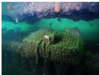
図47 栄養骨材を設置した漁礁 (設置3ヵ月後)
