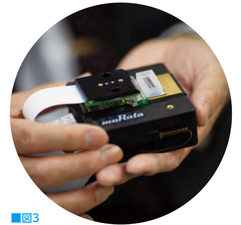
■図3 村田製作所が開発した手のひらサイズの測定装置。ノートパソコンやスマートフォンと接続すれば測定可能で、空港の検疫や鳥小屋などどんな場所でも使える。
