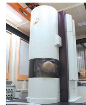
走査型透過電子顕微鏡(STEM)と概要。試料に細く絞った電子を照射し、透過散乱した電子を検出器で検出して観察する手法。
