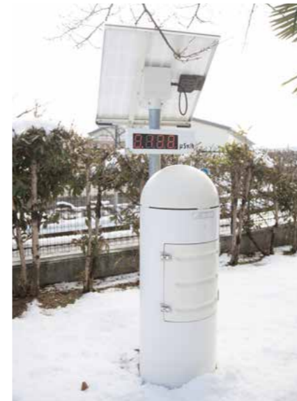
屋外に設置された放射線測定器 (左)。個人積算線量計の測定値を基に、PCでデータ解析する (右)。
