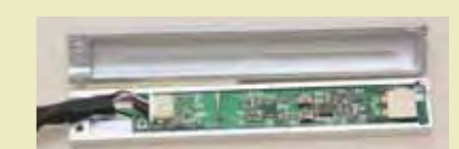
モジュールの内部。右端がTMR素子のセンサー。
