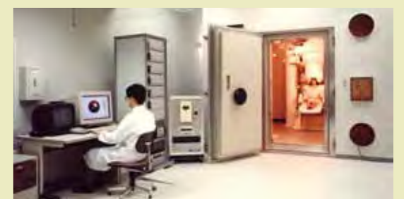
SQUIDによる脳磁気計測。SQUIDは外部の磁気を遮断する大掛かりなシールドルームを必要とする。(写真提供:中里信和教授)
