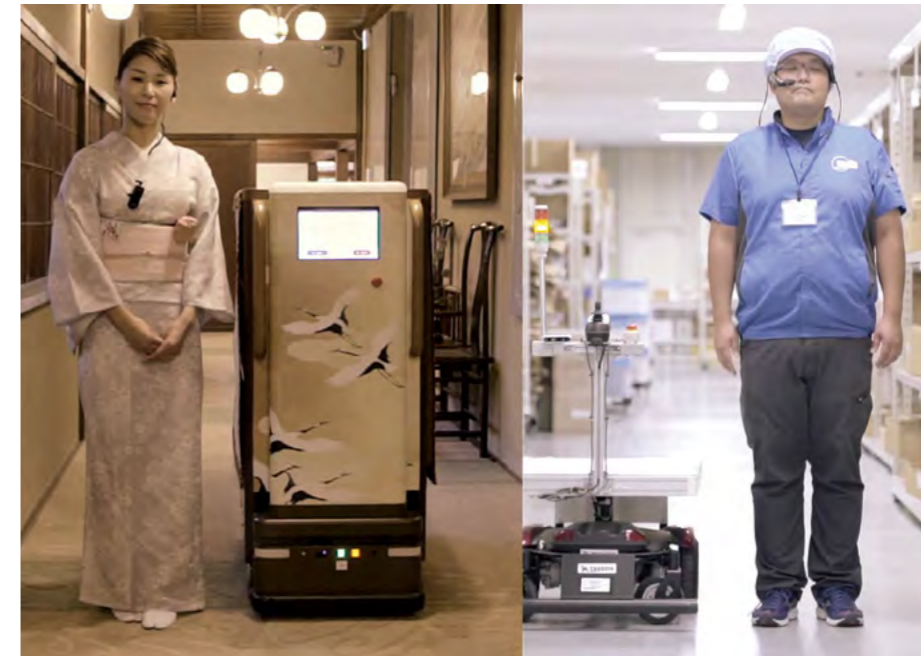
■図5 もともと資材を運搬する工業用ロボットだったが、和装の外観や琴の演奏による搬送表示音声、御簾を用いたドアなど、配膳ロボットとしてサービス提供の現場と調和するものに改装した。現場の従業員が使用できるように、ロボットの停止や発進など基本的機能の操作を容易にした。
