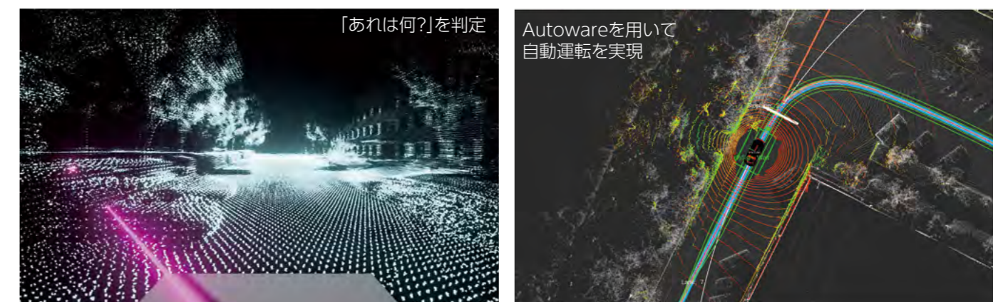
■ 図3 座席にカメラやマイクを取り付け、映像から発話の有無を認識する (左上)。発話の音声に加え、唇の動きや視線の向きなどを感知し、複数の入力を組み合わせさせて高い精度で運転者の意図を認識する技術を開発した。点は顔の部品を認識するための参照点で、黄色は口、水色は目に対応する (右上)。「あれは何?」という指示語を含む発話も、視線の向き (ピンクの線) や地図情報から、具体的な位置を判定する (左下)。収集した情報に基づき、オートウェアを用いて自動運転を行う (右下)。
