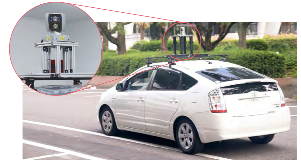
■ 図2 マルチモーダルインターフェース自動運転システムを搭載した車両。自動運転車は、カメラや各種センサーで、歩行者や道路標識など周囲環境の情報を入手し、自車位置を高精度3次元地図と照合して走行する。ルーフの上にあるのはレーダーと呼ばれる装置で、赤外線を発することで周囲の物体までの距離や物体の形を計測する。
