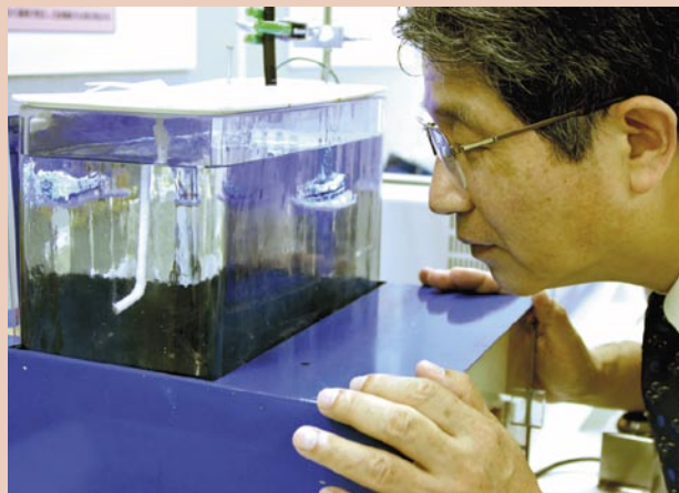
大学院生のときに使った実験装置をのぞき込む藤嶋氏。白いパイプのようなものの中に白金電極があり、水素の泡が出ている。もう一方の電極である酸化チタンには紫外光が当たり、酸素の泡が出ている（下）。装置は、神奈川県科学技術アカデミーの光触媒ミュージアムに展示されている。（総合研究大学院大学提供）
