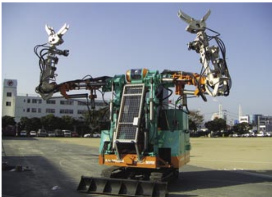
援竜 高さ3.5m、重量5tの世界最大級レスキューロボット。瓦礫の散乱する災害現場で車両用の道造りなどを遠隔操作で行う。近々、2本腕の解体作業マシンとして建設現場に登場する予定。
