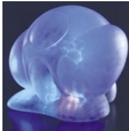
ロボリア カメラ、マイク、人感センサーを搭載し車輪走行。幅27cm、高さ26cm、長さ26cm、重さ約3.25kg。(税込み29万4000円)
