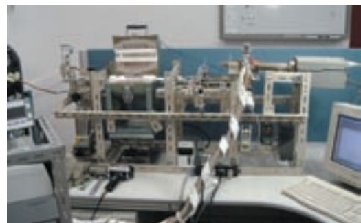
図2 酸素同位体置換用に設計・製作した炉
