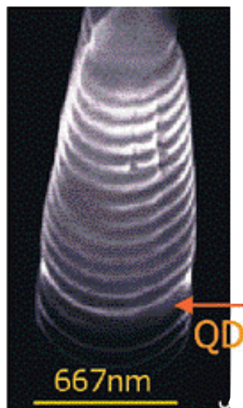
図1 単一光子光源のSEM写真。単一量子ドットが3次元光マイクロキャビティに閉じ込められている。
