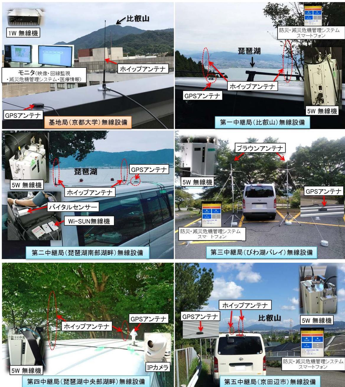
図4 無線局設備構成(各拠点には簡単なアンテナの装備で、拠点間の位置合わせを行わずに中継が可能)
