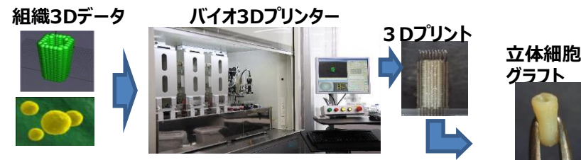
バイオ3Dプリンターによる三次元組織製造フロー
