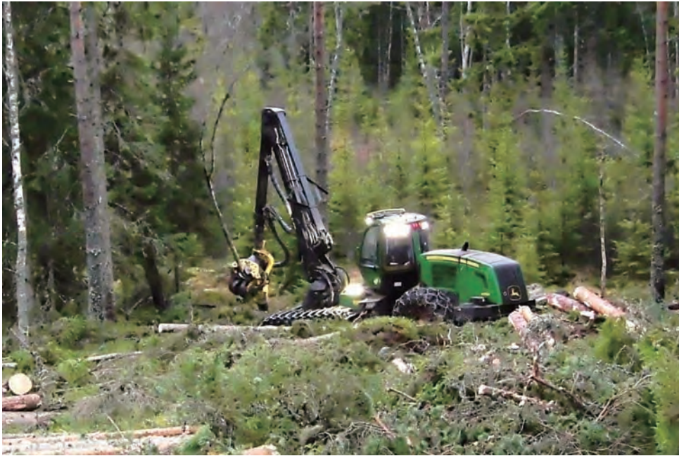
写真 1 ハーベスター 伐採から玉切まで 1 人で 150m 3 /日の収穫が可能 (写真 1,2 場所：スウェーデン 撮影：2014 年 11 月)
