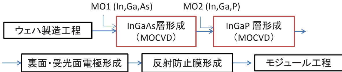
図4 III-V族3接合タンデム太陽電池の製造工程
