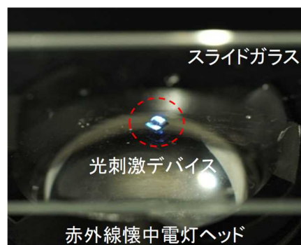
図 2: 完全ワイヤレス・インプラントブル光操作デバイスの動作の様子
