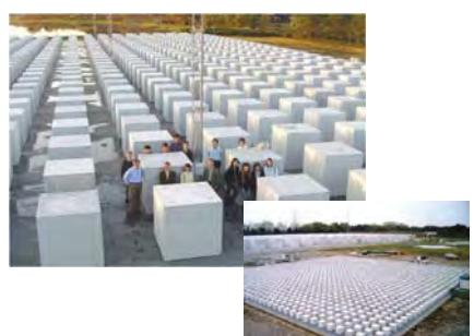
【図3】屋外スケールモデル実験施設COSMOを構築し、都市幾何構造や植生の配置が水・エネルギー強制力に及ぼす影響を調べている。100m × 50m の敷地に1辺が1.5m のコンクリートブロックを並べられている。
