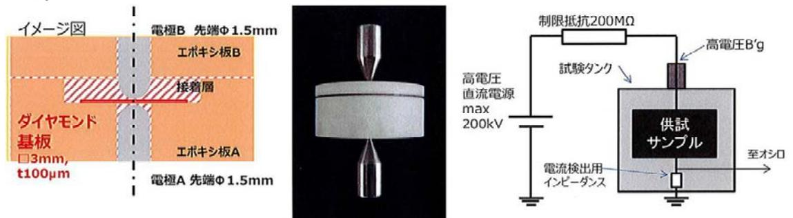
図17 高電圧測定に用いた測定モジュールの(a)模式図および(b)写真、(c)高電圧試験回路模式図。
