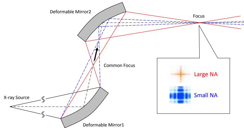
図10 開口数を自由に制御できるアダプティブ集光光学系の概略図.
