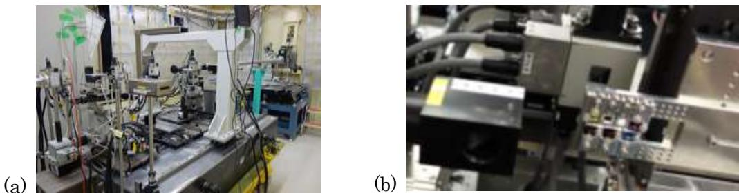
図20 コヒーレント X 線イメージング試料ユニット
