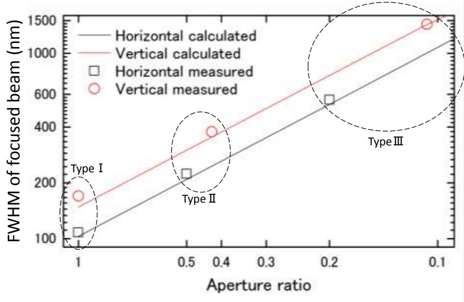
図12 開口数制御によって得られたビームプロファイル(上)と開口数のビーム半値幅の関係(下). Type I ~ IIIは設定した開口数によるタイプ分けを意味する(下グラフに対応). Aperture ratio は実現できる最大開口数に対する比率を意味する. つまり 1 は最大開口数の光学系の場合である.
