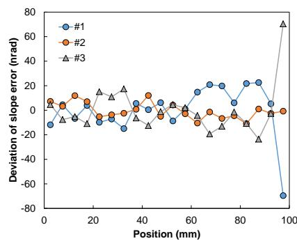
図7 (左)ビームを 12.5nm ピッチで走査した際のビームモニター上で重心位置変化. (右)形状可変鏡を使ってテストされたペンシルビーム法の測定再現性.  $\pm 25\text{nrad}$  の精度で形状可変鏡上に存在するスロープエラーを検出することに成功した.
