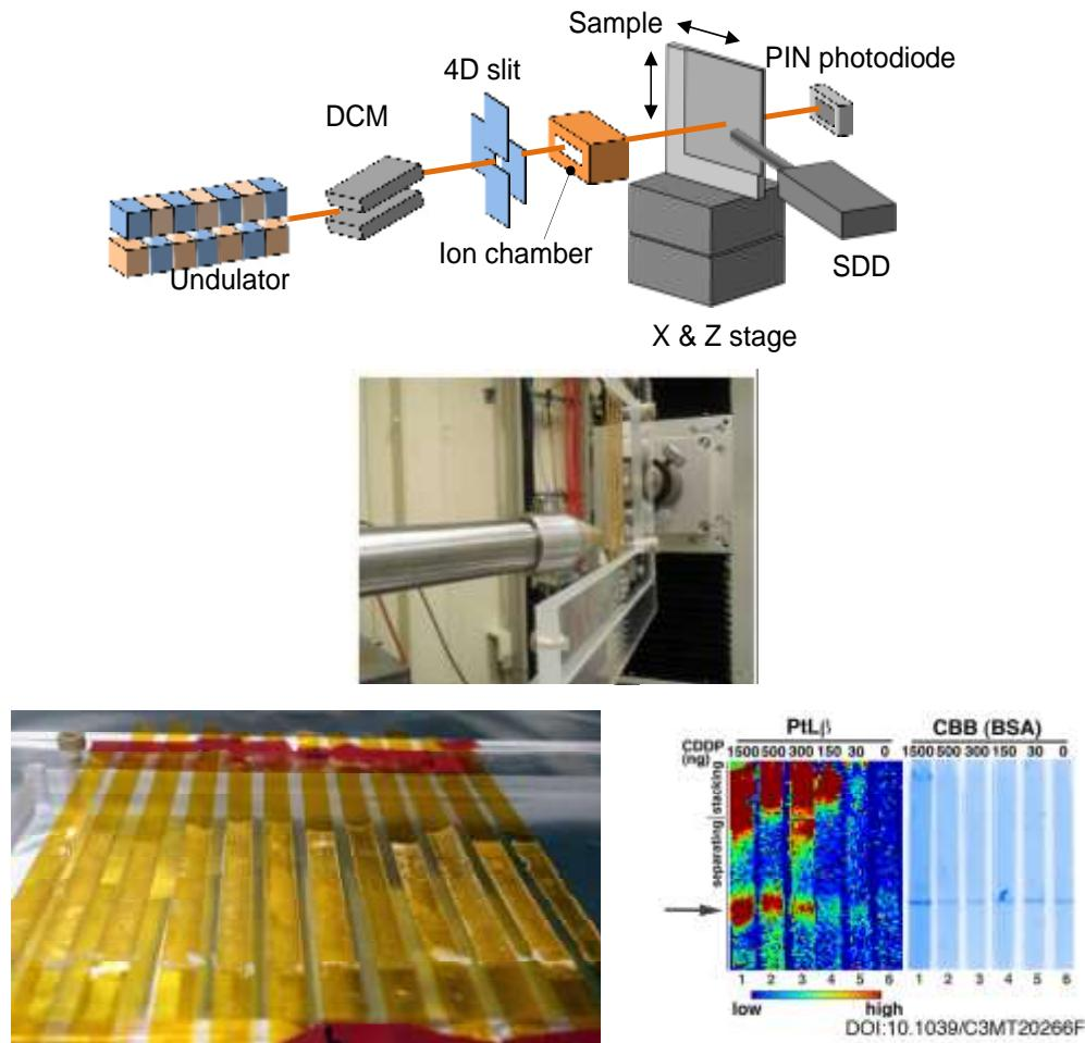
図24 (上, 中段) SPAX の装置構成と試料部分の写真、(下左)開発した native-gel フィルムと(下右)SPAX の検出下限評価の結果。白金製剤(CDDP)を 0~1500ng 添加した血液中蛋白質を試料とし、Pt L $\beta$  線を中心に分析をしたところ、検出下限として 80ng を達成した。
