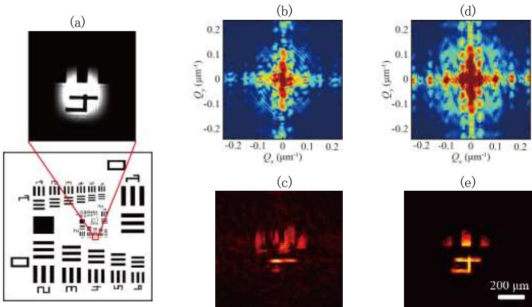
図17 可視光レーザーを用いた非孤立試料のコヒーレント回折イメージングの実証実験。
