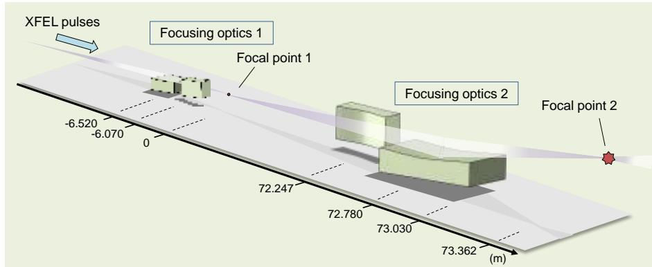
図13 SACL A にて構築された sub-50nm 集光光学系。2段の Kirkpatrick-Baez ミラー光学系から成る。数値は第一焦点からの距離を表す。
