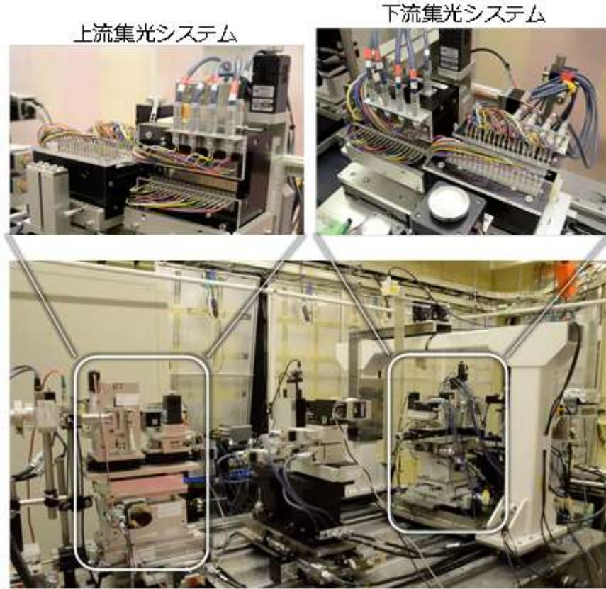
図9 構築した実験セットアップ。振動を抑えるために石定盤上にすべての光学機器を配置した。様々な集光光学系が構築できるように、高剛性リニアガイドが設置されている。門型の可動式ユニット上にオートコリメータや各種検査機器が設置できるようになっており、光学素子の高精度かつ迅速なアライメントが可能である。
