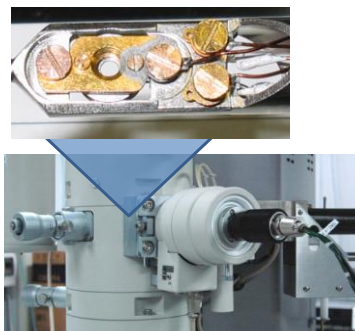
図 32 グリッドの温度変化とグリッドに電位を印加できるように改造したホルダー(上)と、それを取り付けた TEM(下)。
