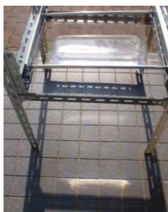
水レンズの試作1号機。太陽光が床パネルに焦点を結んでいる。
