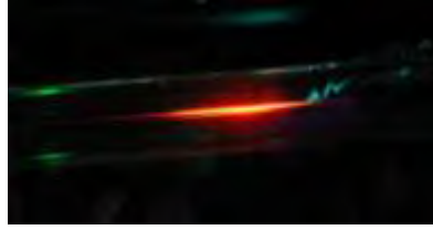
図1 \omega と 2\omega をNe ガス中に集光した場合のフィラメント(長さ約 15 cm)
