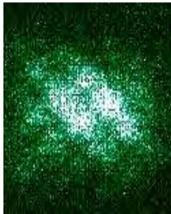
図4-1-4 高NAの対物レンズによる2次元光格子中のYb原子の発光イメージング画像。約6ミクロンのモアレパターンが明瞭に観測されている
