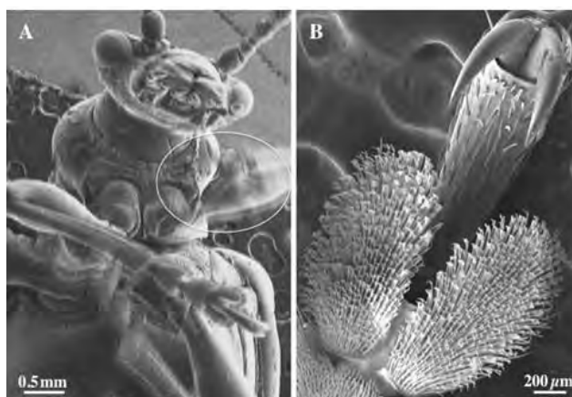
図13 ハムシにナノスーツ法を適用した電子顕微鏡観察
