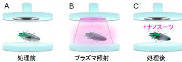
図10 プラズマによる表面修飾の模式図
