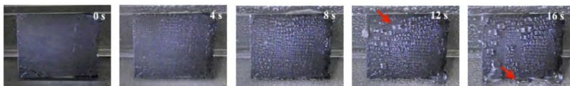
図24 濡れ性パターンニングした剣山様シリコンによるゴミムシダマンの水捕集表面模倣
