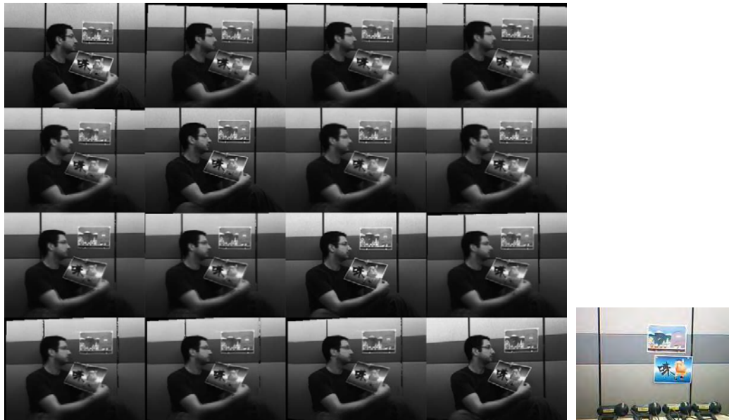
図5: 4台のカメラで撮影した映像からリアルタイムで距離画像を生成し、距離画像を利用して4台のカメラの補間映像を生成した例
