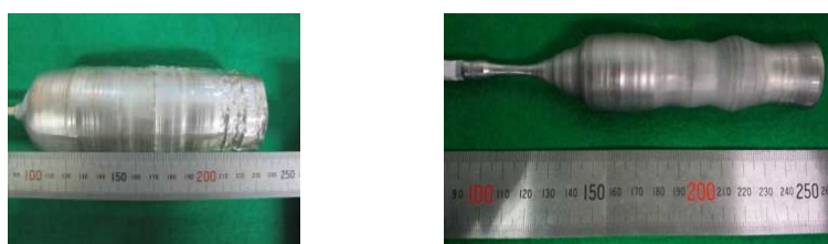
写真 3 CZ 法で作製した単結晶合金の例
