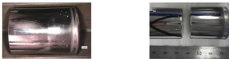
写真 4 一方向凝固法で作製した単結晶合金の例
