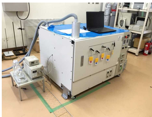
図 2. 高圧水素発生装置
