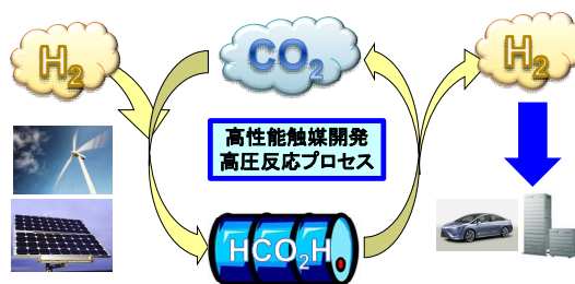
図 1. 二酸化炭素/ギ酸の相互変換を利用した水素貯蔵システム
