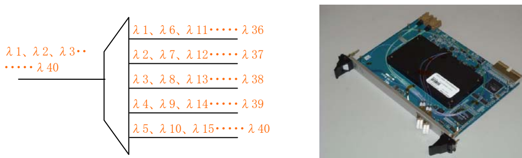
図 33 分散配置型波長群合分波器の動作と実装後の写真
