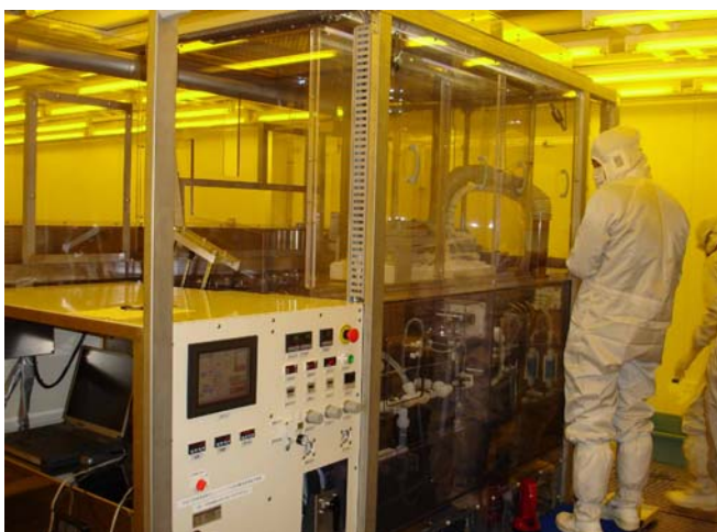
図 17 TFT 用硝酸酸化装置
