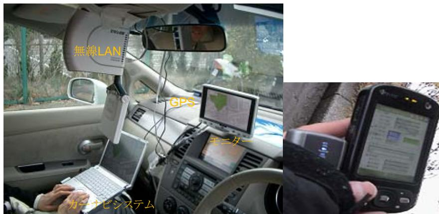
図 4-3.2-3 対人事故予防ネットワークセンシングシステムプロトタイプ
