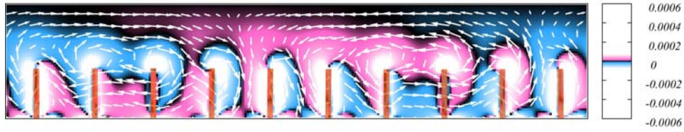
図1-11: レイリー波によって駆動される弾性板に誘起する流れ。 矢印は速度ベクトル, カラーは流れの渦度を表す(Re=0.15).
