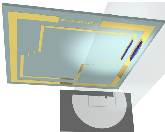
図(a):吸収画像計測の模式図。図の右上方より共鳴光を入射し、原子の吸収画像を撮影
