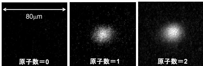
図5 磁気光学トラップ中の单原子の蛍光像
