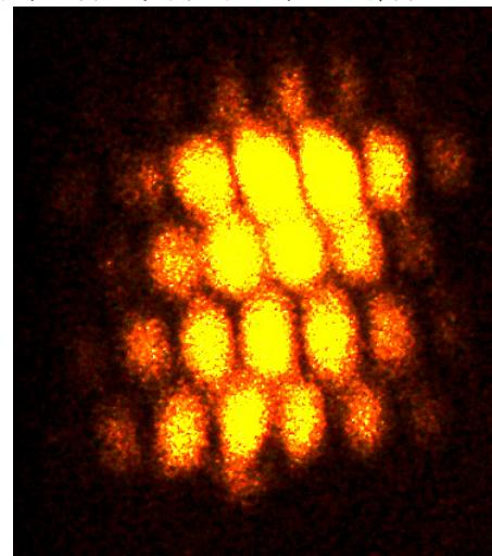
2006年度(H18年度)は、対向ポンピングの場合に起こる、4光波によるパラメトリック増幅と発振を理論的、実験的に解析し、時間相関を持った4光波の観測、4つ子の光子発生の可能性に関して検討した。対向ポンピングの場合、mirrorless cavityと呼ばれるフィードバック効果により、共振器なしでも強い発振に至る。特に、ナトリウム蒸気の系の場合は、オフアクシスに照射される4本のビーム(ストークス光、アンチストークス光)が同時に成長し、最終的には発振に至ることが実験的に示された。(JOSA B25, 40 (2008))
