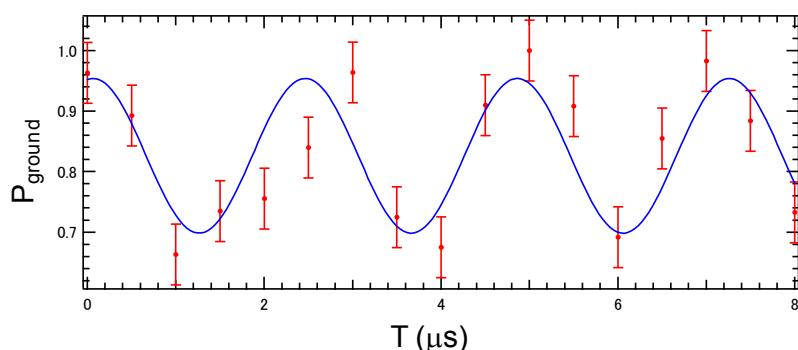
図6 Rb原子のRydberg状態への励起によるラビ振動の観測
