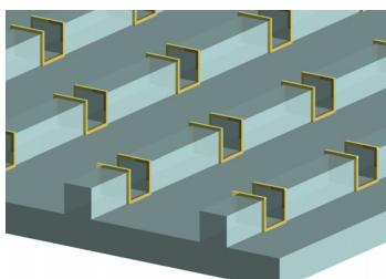
図(b)：チップ上の立体型トラップの模式図（黄色の部分が超伝導電線）
