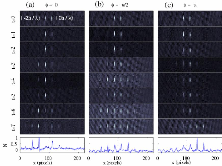
図3  $t$ 回キック後のBEC原子の運動量分布
