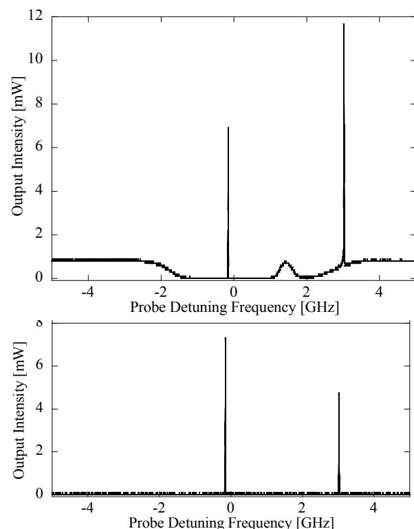
はプローブ光の透過スペクトルで、2光子共鳴条件を満たす2つの周波数において、高い利得が観測されている。下図は、同時に発生するアイドラー光強度をプローブ周波数でプロットしたもので、プローブ光とアイドラー光は、同時に、しかも同程度のパワーで発生していることがわかる。)これは、原子密度が高く、かつカプリング光強度が強い場合にのみ観
