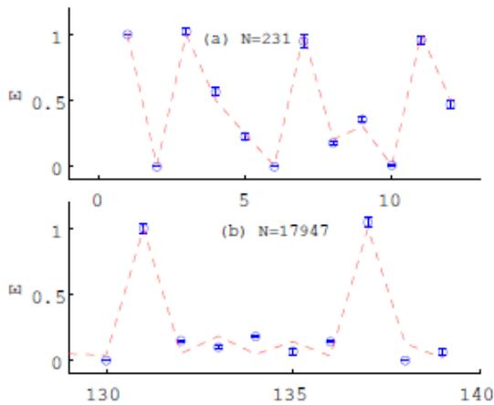
図4 ガウス和による整数Nの因数分解の実験結果
