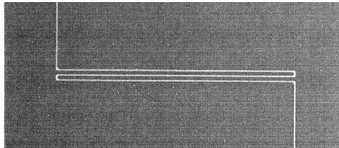
図：平面バイアスフリー型トラップの SEM 写真
