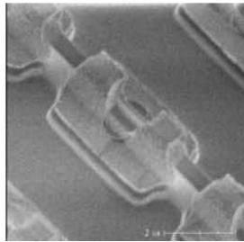
図(c):作製した立体型トラップ1個の SEM 写真
