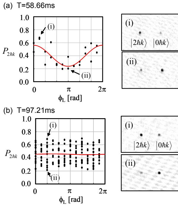
図2 トランプ BEC 干渉計の干渉フリンジ信号
