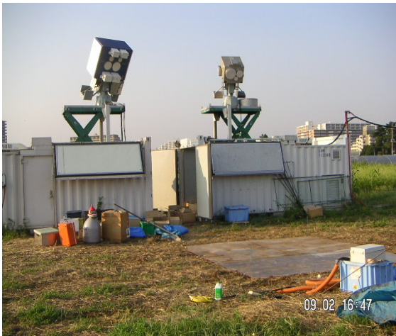
図1 2台のマイクロ波放射計による地上観測実験 (左：観測風景，右：共通のターゲット領域)
