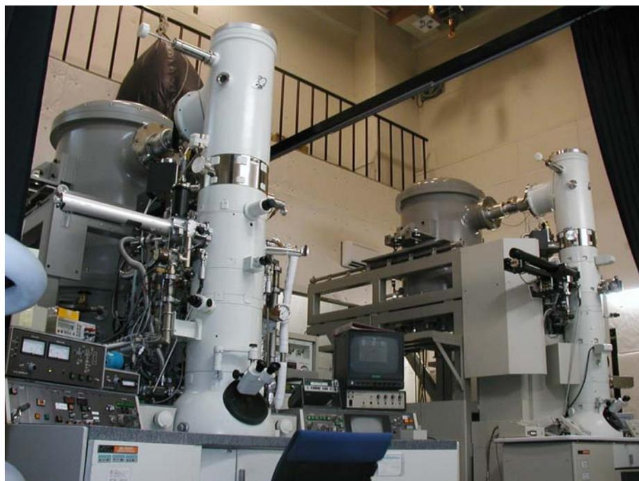
傾斜機構の無い極低温電子顕微鏡（手前）と、傾斜機構付き極低温電子顕微鏡（奥）
