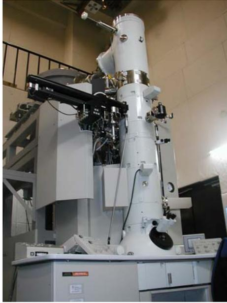
図3 第6世代の極低温電子顕微鏡。自動試料交換機構と傾斜機構、高性能高分解能CCDカメラなどを装着している。トモグラフィー用の電子顕微鏡像を撮影することが出来る（本体は別予算で開発）。
