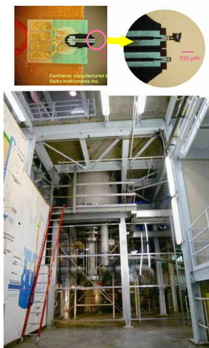
単一分子性金属、 [\text{Ni}(\text{tmdt})_2] の微小単結晶の磁気トルク実験によるドハースーファンアルフェン振動観測がなされた米国国立強磁場研究所 National High Magnetic Field Laboratory(NHMFL)の45 テスラのハイブリッド磁石と用いられた結晶試料
