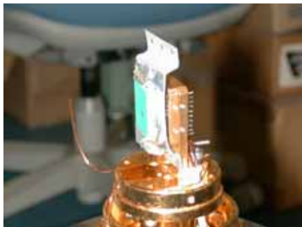
図 12: MgB 2 検出器にアルファ線を照射するために低温ステージに試料マウント
