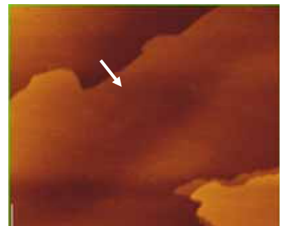
図 28 液相成長 DT-TTF 単結晶の AFM 像
