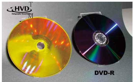
図 60 コリニア方式による動画の記録再生に使用したホログラム光ディスク: HVD (直径 12 センチで, 右側に置かれた現行 DVD や CD と同サイズ).
