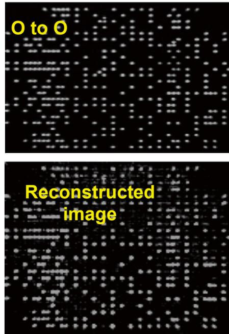
図 23 MOSLM を用いたコリニアホログラム記録再生試験結果:O to O(上), 再生像(下)。
