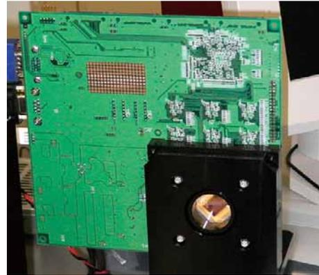
図 64 作製した CMOS センサボード.
