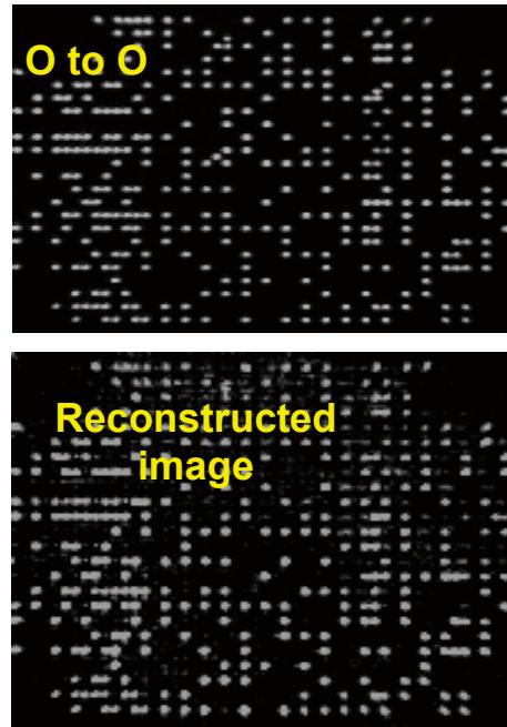
図 23 MOSLM を用いたコリニアホログラム記録再生試験結果:O to O(上), 再生像(下).
