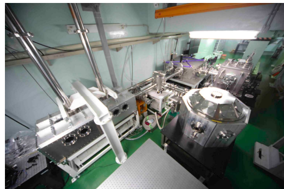
図2 レーザーパルス真空伝送線路と LVC 電子入射器真空容器
