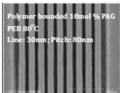
図 8. ポリマーバウンド PAG レジストのパターン SEM 像
