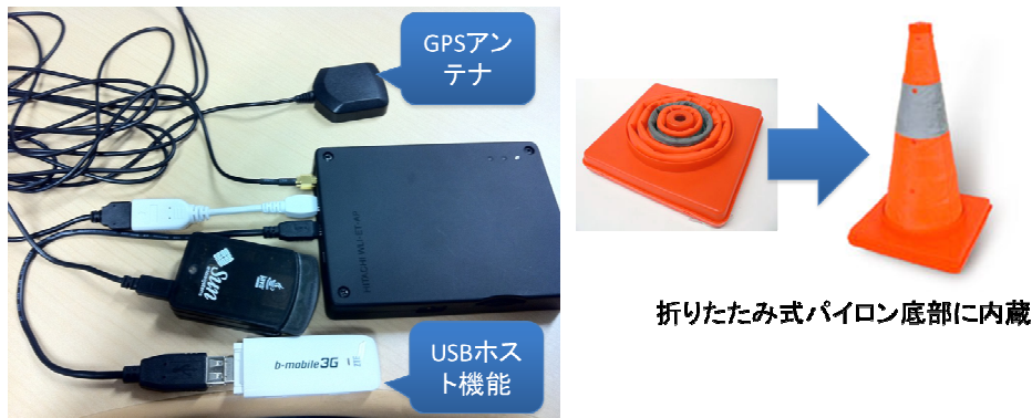
図2:パイロン型基地局
