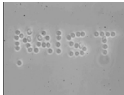
図7 パルスアシスト光ピンセットによる吸着性基板上での粒子の配列操作
