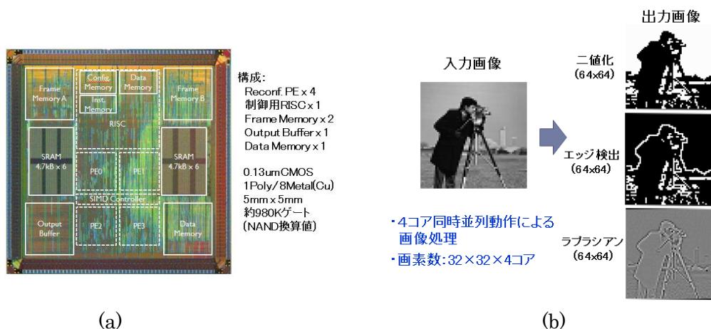
図6. 試作したマルチコアプロセッサ・テストチップの顕微鏡写真(a)と画像処理結果 (b)
