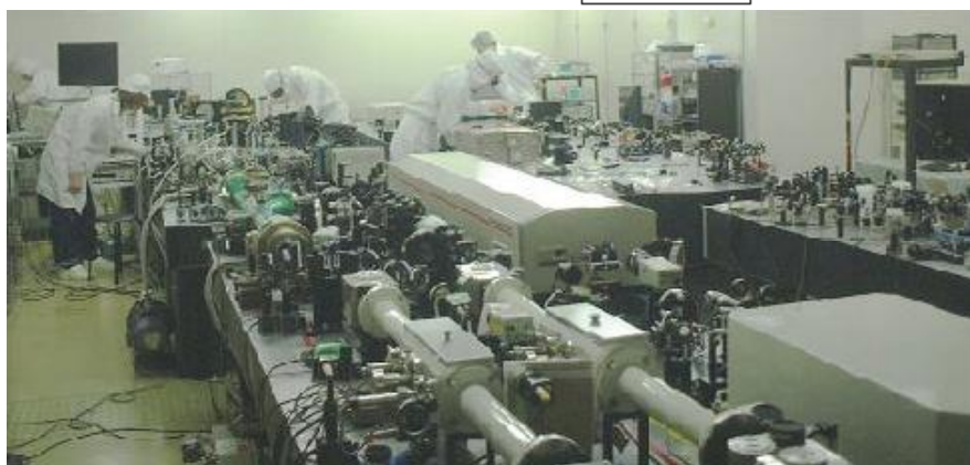
図 1 開発中の装置の詳細構成ブロック図 (上) と写真 (下、手前が CPA DPSSL、奥がファイバーレーザーと OPCPA 部)。
