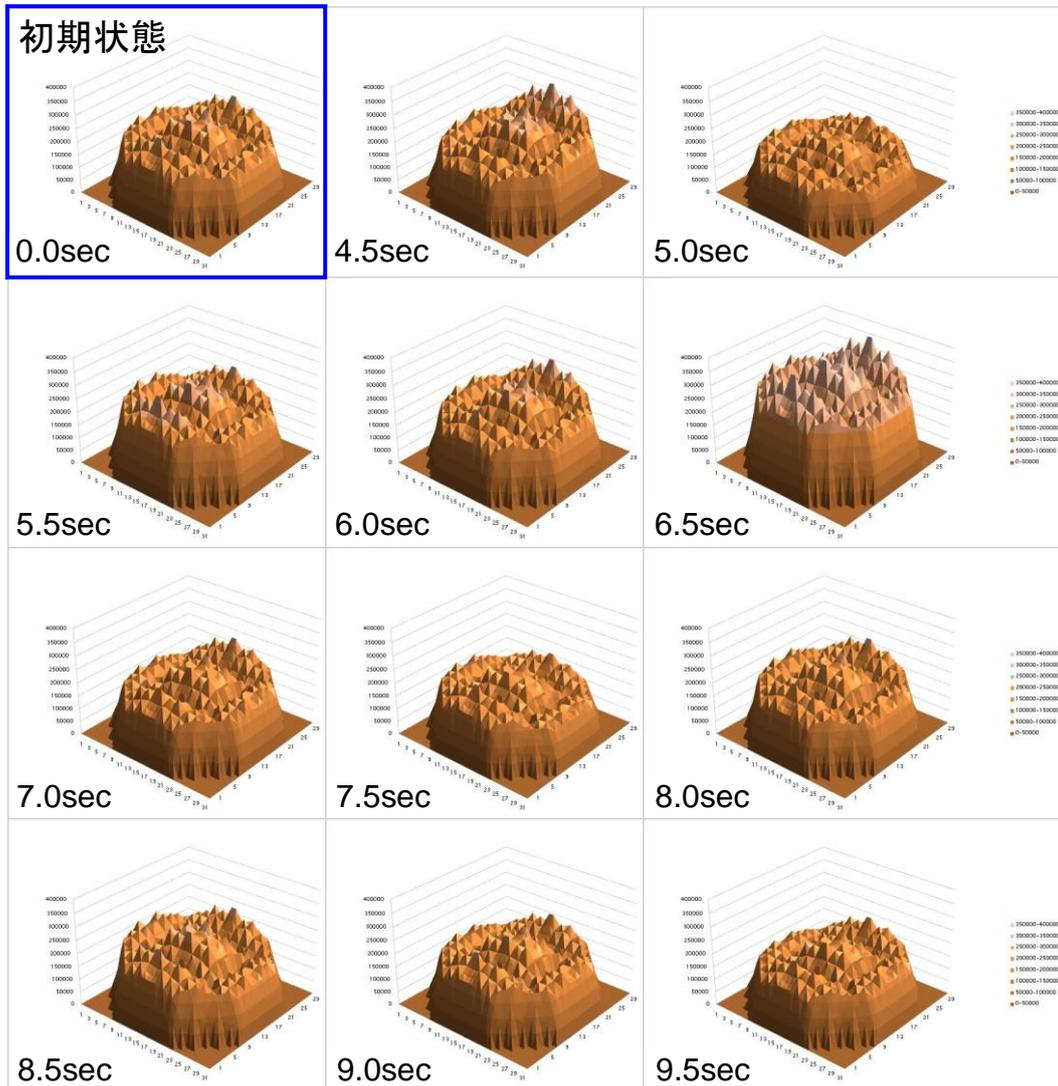
図 3. 炉心水平断面内セル出力分布の時間変化
