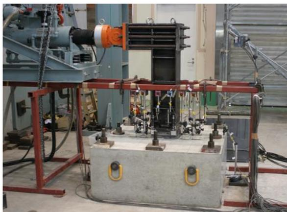
図 6. 建屋・機器接合部位の載荷実験
