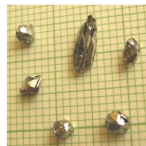
図11 新フラックス法で育成した \beta\text{-FeSi}_2 単結晶
