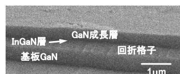
図15 回折格子埋め込み成長後の鳥瞰 SEM 像
