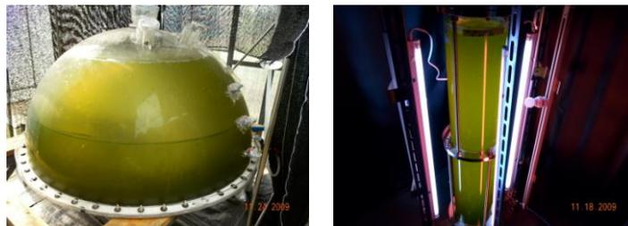
図4. 屋外閉鎖系培養装置(左)と室内開放系培養装置(右)
