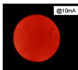
図4 10mA 注入時の発光写真
